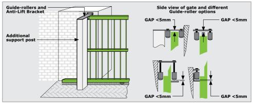
FIGURE 5. FITTING GUIDE-ROLLERS
