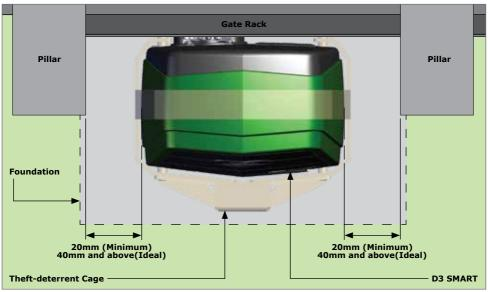
**FIGURE 9. MINIMUM CLEARANCES - SIDES**
