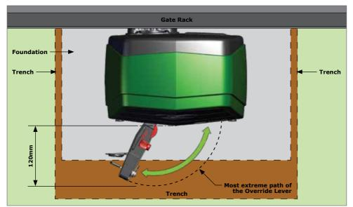
**FIGURE 10. MINIMUM CLEARANCES - FRONT**
